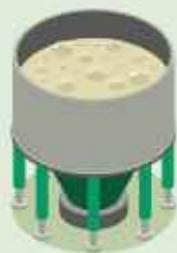
▶ **Cocción.** Las astillas se cocinan durante algunas horas en una mezcla de productos químicos, los más comunes incluyen hidróxido de sodio (sosa cáustica) y sulfato de sodio. La combinación de calor y químicos rompe la lignina, sustancia que une las fibras de celulosa en la madera. Al romperse se liberan las fibras de celulosa creando una mezcla pulposa conocida como pulpa.
