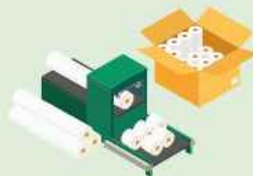
▶ **Prensado, secado y raspado de papel.** El papel se raspa con unas cuchillas metálicas y se enrolla en bobinas gigantes, luego se traslada a máquinas que lo cortan en tiras largas y lo perforan en cuadrados. Al final, los cilindros de papel resultantes se cortan en rollos y se envuelven en paquetes.
