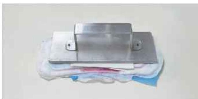
Una vez transcurrido ese tiempo, se retiró el papel filtro, previamente pesado, y se pesó de nuevo para medir la cantidad de humedad liberada por la toalla. Así, se calculó la diferencia entre la masa del papel húmedo y su peso inicial cuando estaba seco, lo que permitió determinar el valor de humedad regresada. De esta forma se midió la cantidad de humedad que la toalla es capaz de absorber y retener durante cada descarga.
